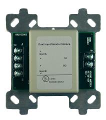
El Módulo de Monitoreo de Doble Entrada FLM-325-214 cuenta con dos circuitos de control de contacto independientes a pesar de que sólo utiliza una dirección del lazo SLC. El módulo se puede programar para que supervise contactos secos de tipo Normalmente Abierto (NO) o Normalmente Cerrado (NC) de los dispositivos de detección de incendios y de supervisión como, por ejemplo, estaciones manuales de alarma o dispositivos de flujo de agua.
