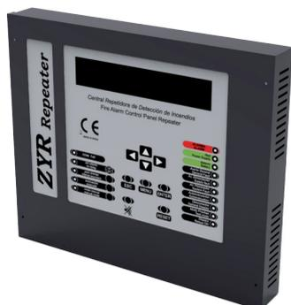
La central LYON / ZAFIR / COMPACT Lyon permite conectar hasta un máximo de 15 repetidores, mediante una conexión de 4 hilos de 1,5 mm<sup>2</sup> (dos de alimentación y dos de comunicación para la línea RS485). Los dos hilos de la línea RS485 se conectarán desde la central a los correspondientes repetidores. El conexionado de los repetidores se realiza como se muestra en la figura adjunta.
